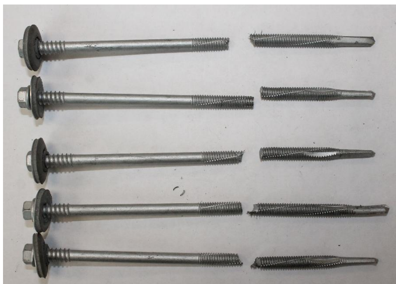
Рисунок 13. Типовой вид разрушения при испытаниях на вырыв из Ст3 8 мм и на растяжение
