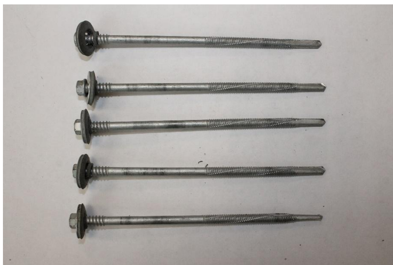
Рисунок 14. Типовой вид разрушения при испытаниях на вырыв из Ст3 4 мм
