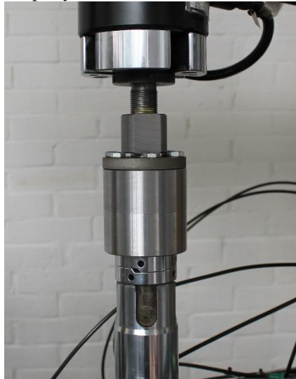
Рисунок 9. Общий вид испытательной установки для испытаний на вырыв листа через шайбу
