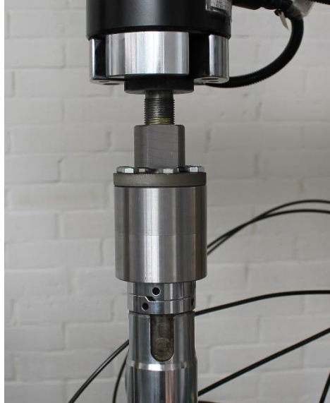
Рисунок 3. Общий вид испытательной установки для испытаний на растяжение
