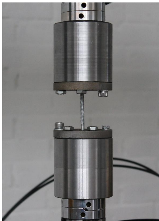
Рисунок 5. Общий вид испытательной установки для испытаний на вырыв из стали
