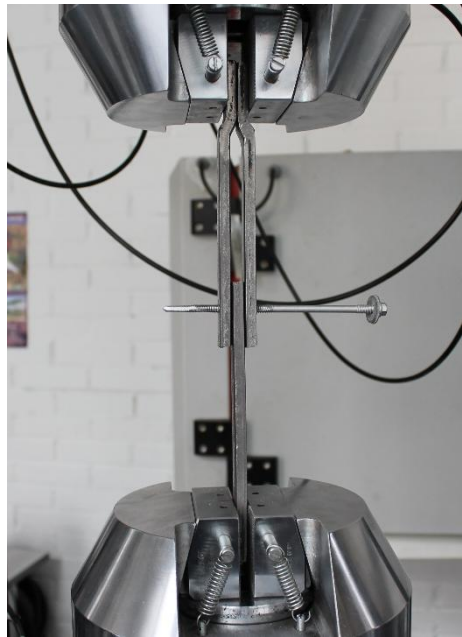
Рисунок 1 – Общий вид испытательной установки для испытаний на срез
