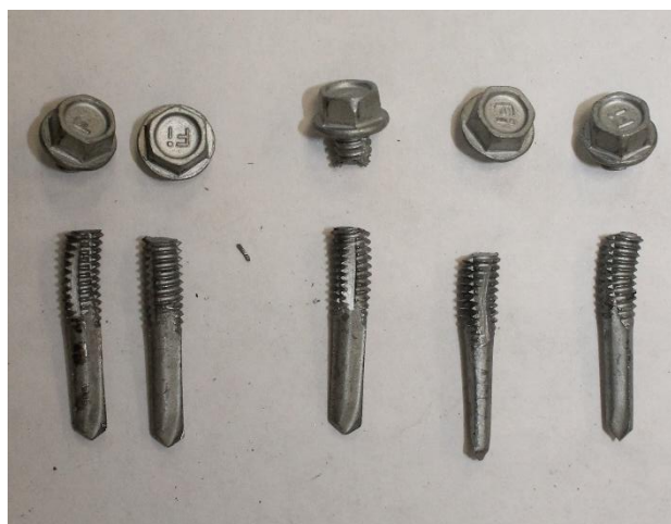
Рисунок 12. Типовой вид разрушения при испытании на срез
