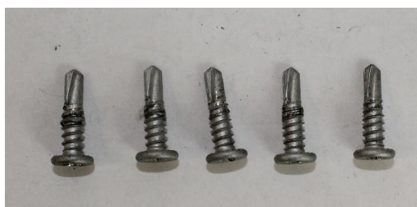
Рисунок 15. Типовой вид разрушения при испытаниях на вырыв из С350 2 мм
